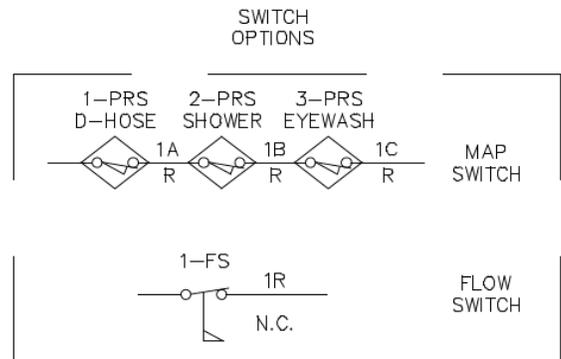
**Figura 8A. DIAGRAMA DE CABLEADO – 120 V**
