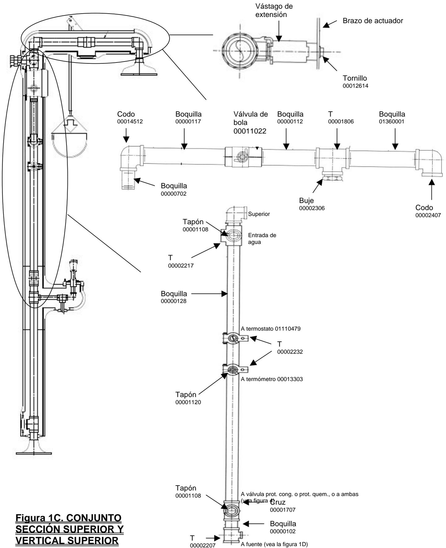
**Figura 1C. CONJUNTO SECCIÓN SUPERIOR Y VERTICAL SUPERIOR**
