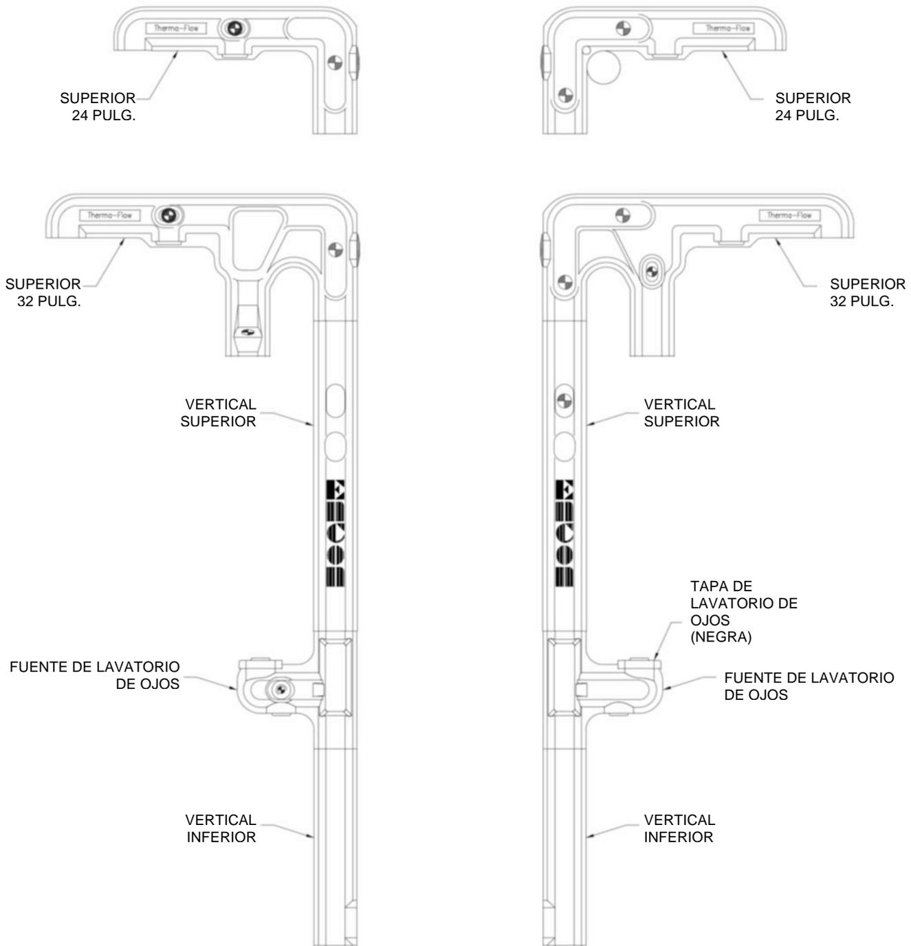
**Figura 9. CONJUNTOS DE CUBIERTA**
