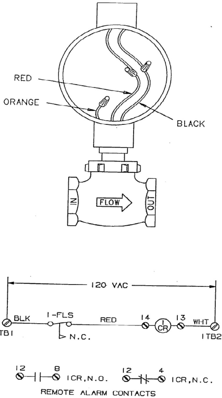
**Figura 6A. INTERRUPTOR DE FLUJO Y ESQUEMA**
