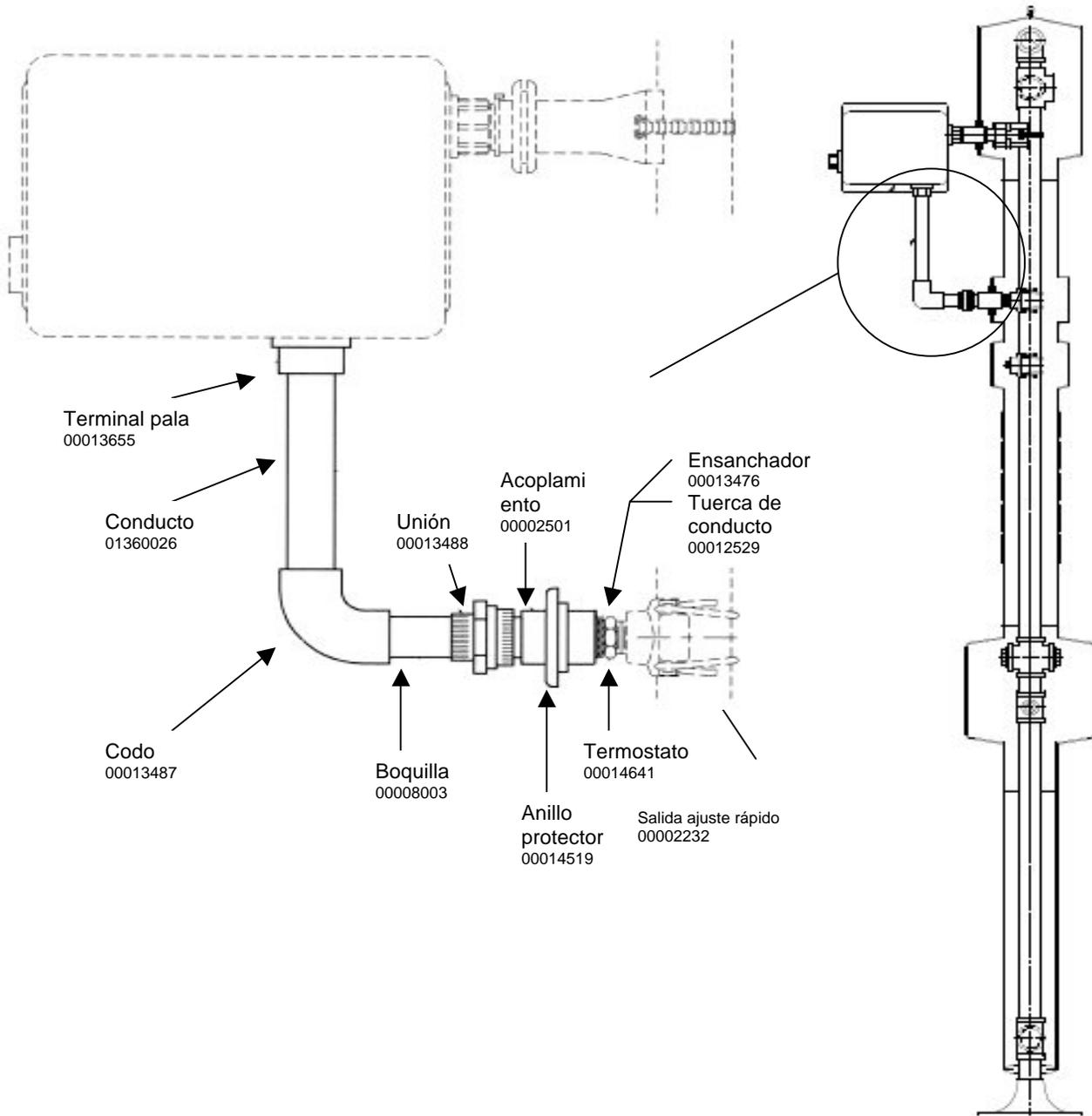
**Figura 1E. CONJUNTO DE TERMOSTATO**
